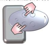
**5-**PLACE THE REMOTE CONTROL TO BE CLONED BACK TO BACK WITH "AIR4".
